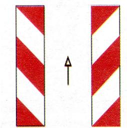
**Znakovi K12-1 "Ploča za označavanje bočne zapreke"**
